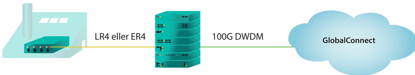
Figur 2: Op til 10 km til GlobalConnect PoP med LR4 og op til 40 km til GlobalConnect PoP med ER4-transceiver.
